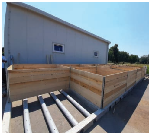
Slika 12. Kompostnik s perforiranim cijevima za pasivno aeriranje
